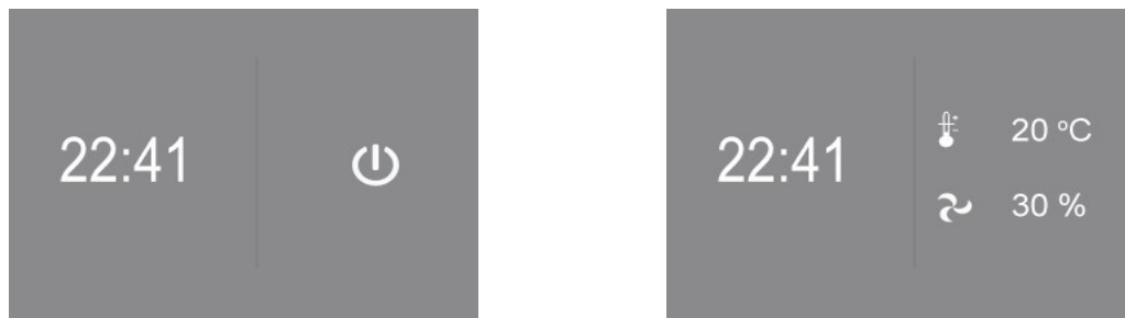
Pav. 18. Pultas LCD ekranėliu budėjimo režime, išjungtas ir veikiantis įrenginys
